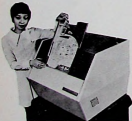
Afb. 3. Telenewspaper-receiver Model AT-3 van Toshiba. Op deze wijze wordt een krant draadloos (en fietsloos) bij u thuisbezorgd.
